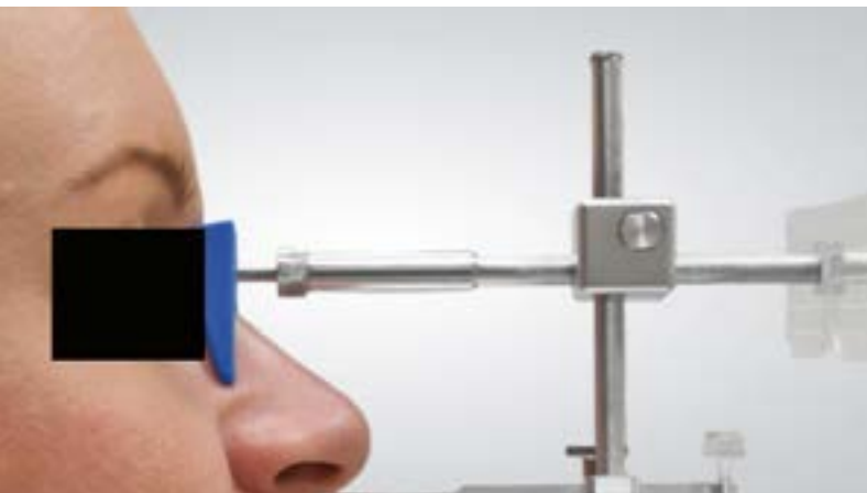
02 Ansicht der Nasenstütze inklusive des Bipupillarlineals. Die Nasenstütze kann zudem vertikal nach der Camperschen Ebene und der Patientenhorizontalen ausgerichtet werden.
