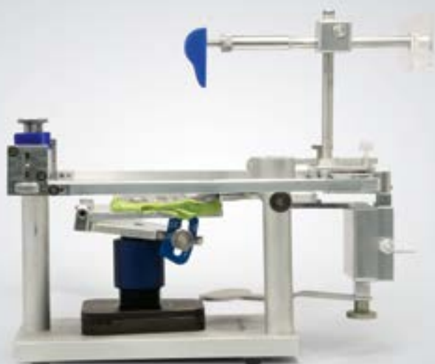
11 Der Gesichtsbogen wird mit der daran befestigten Bissgabel in den Übertragungsstand eingestellt. Die Aluwachsplatten werden mittels Bissilikon auf dem Übertragungstisch fixiert.
