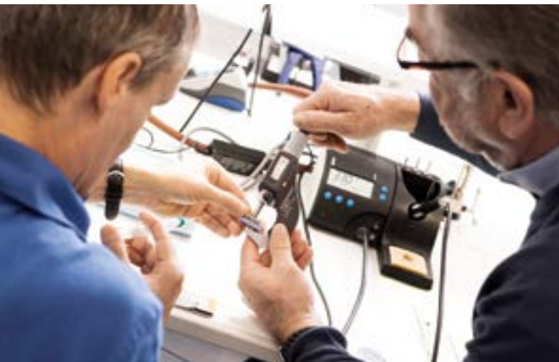
Kontrolle minimaler Toleranzen des Kreuzschiebetischs (li.). Eine hohe Präzision bildet die Basis für ein Registersystem. Die Fertigung erfolgt am Standort in Chemnitz. Hier werden die Komponenten nicht nur erdacht, sondern auch zusammengebaut
